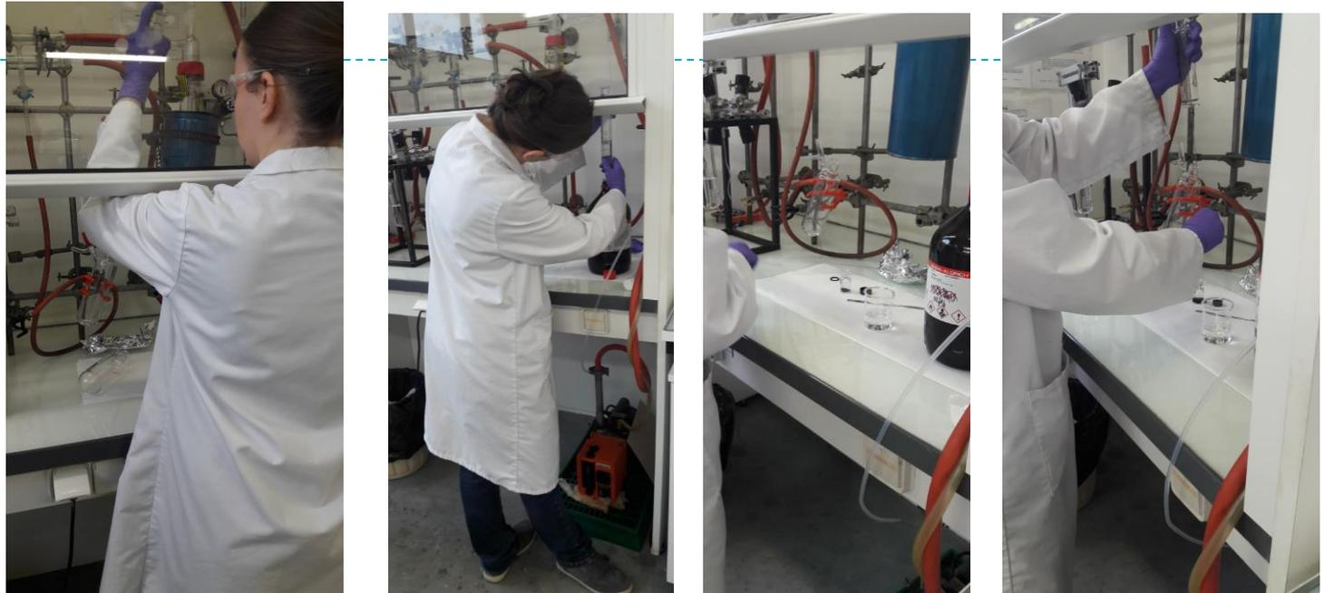
Hotte conforme au niveau de la vitesse mais pas forcément au niveau du confinement
